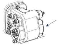
Установите КОМ на КПП. Изменяя кол-во прокладок, добейтесь 5. желаемого результата. Эта проверка производится при выключенном двигателе автомобиля. Автомобиль во время проверки должен быть зафиксирован стояночным тормозом;
