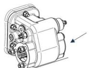
Закрепите гайками КОМ на КПП. Усилие при затяжке гаек не должно 6. превышать 50Нм. Затяжка гаек производится динамометрическим ключом. Проверьте, какой тип и уровень масла указан производителем КПП. При необходимости замените масло и долейте до указанного уровня.
