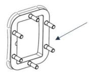
4. Установите одну или более прокладок (при необходимости) из монтажного комплекта. Кол-во прокладок определятся исходя из того, что люфт между зубьями шестерен КОМ и КПП должен находится в пределах 0,15 / 0,3 мм;
